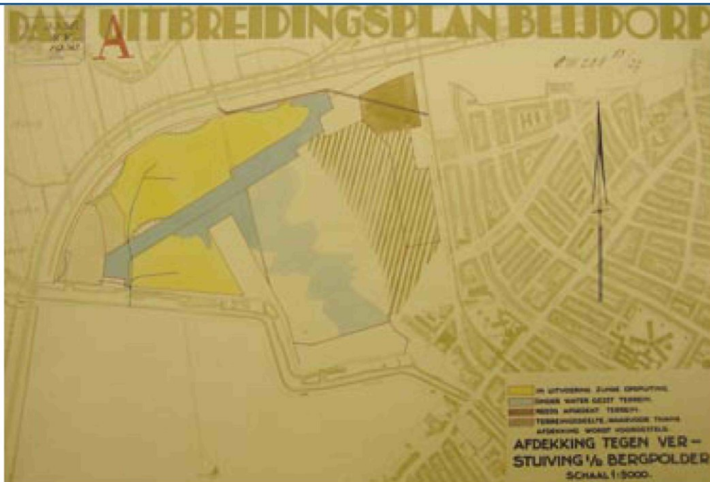
afb.4. De uitbreiding in Blijddorp werd bouwrijp gemaakt door zand op te spuiten. Ten zuiden van de Schie werd het zand in 1924 opgespoten; tijdens het opspuiten van de Noordzijde werd met behulp van water verstuiving van het zuidelijk deel tegengegaan. (GAR, Archief van Plaatselijke en Gemeentewerken portfolio 4V, tekening nummer 3336 1930)
