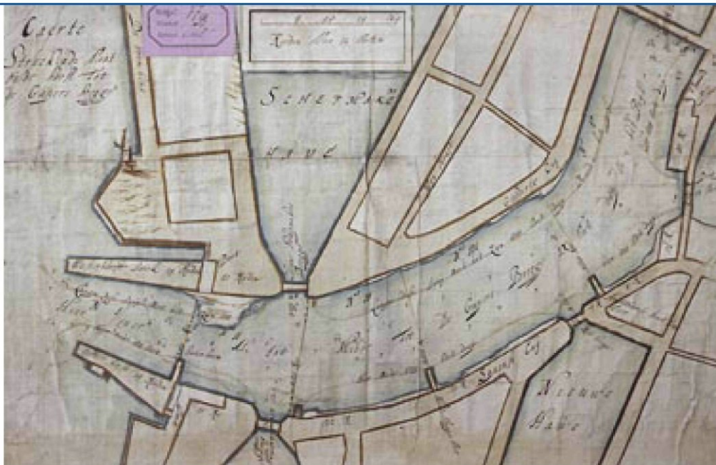
afb. 2. Caerte strekkende van 't Oudehoofd tot de Gapersbrugge. Op dit kaartje zijn de gepeilde waterdiepten aangegeven. Met een dieptelijntje staat aangegeven op welke wijze de haven moet worden uitgediept. Manuscriptkaart uit circa 1650, vervaardigd door Dirck Davidszn. Versyden, op papier op linnen, 34,5x51 cm., schaal circa 1:900. (Kaartencollectie GAR, Plaatselijke Werken (PW), portef. B nr. 77)
